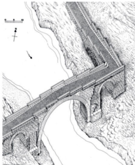
30. 'alignement à angle droit' : pont sur le Göksu ( Singas ), affluent de l'Euphrate, en Turquie.
